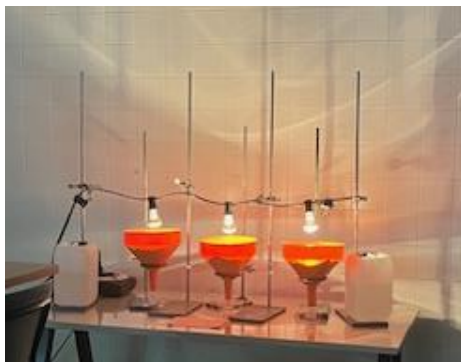
Figuur H: Berlese trechter opstelling. De warmtelamp verwarmd de grond, hierdoor kruipt het bodemleven naar beneden en valt in het bakje isopropanol.
